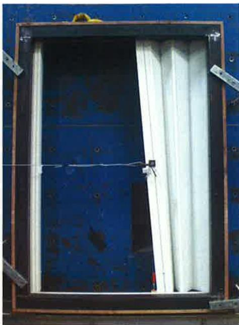
Essai fausse manœuvre sens repliement
